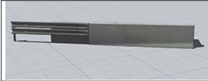
Schutzplanke Übergang Schutzmauer
