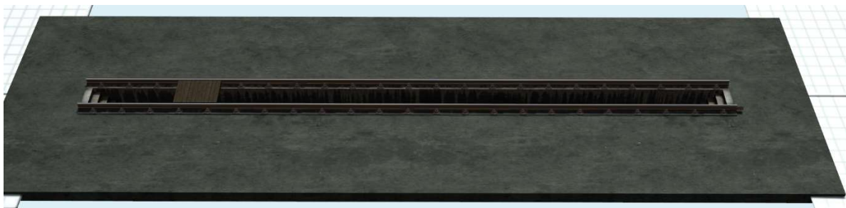
Beispiel an der Schlackengrube mit einer Abdeckung „Schlackengrube_750mm Abdeckung Holzbohlen“.
