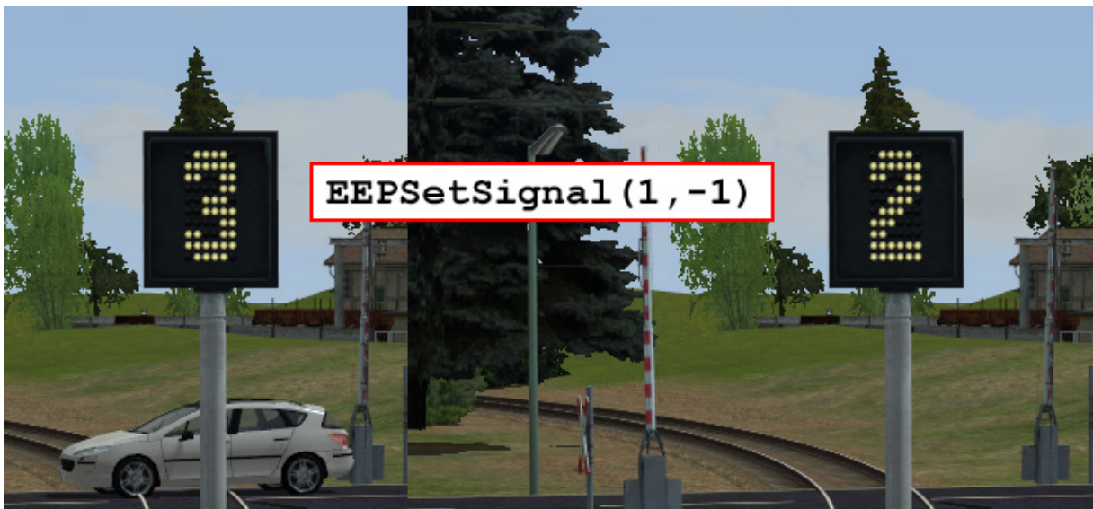
Abb. LUA-Befehle für den Zustandswechsel eines Zählers.
