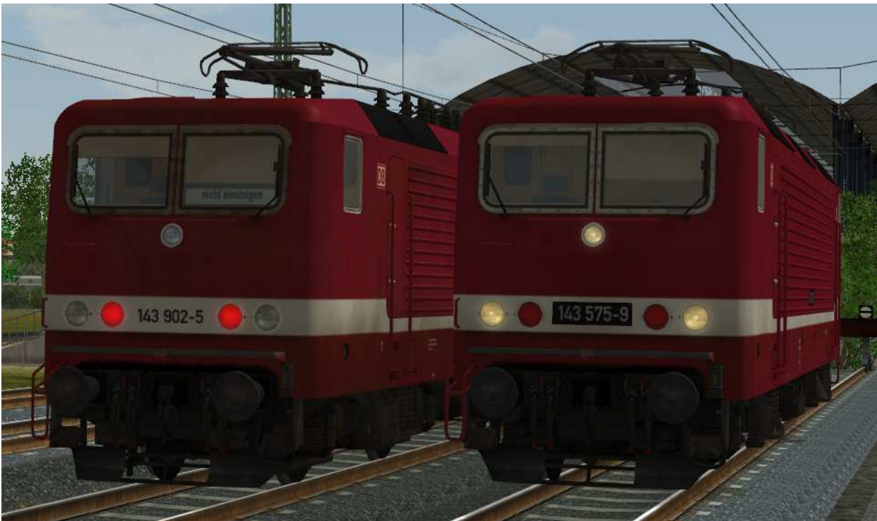
Beleuchtung: 2-Licht-Zugschluß- (links) und 3-Licht-Spitzensignal (rechts)
