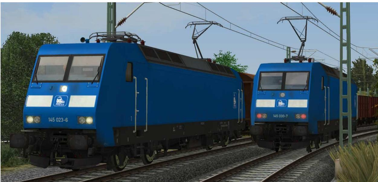
Beleuchtung: 2-Licht-Zugschluß- (rechts) und 3-Licht-Spitzensignal (links)
