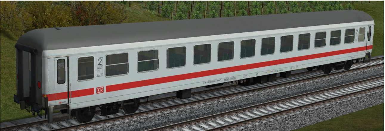
IR-Wagen 2.Klasse mit Fahrradabteil – mit offenem WC-System und Mehrspannungseinrichtung
