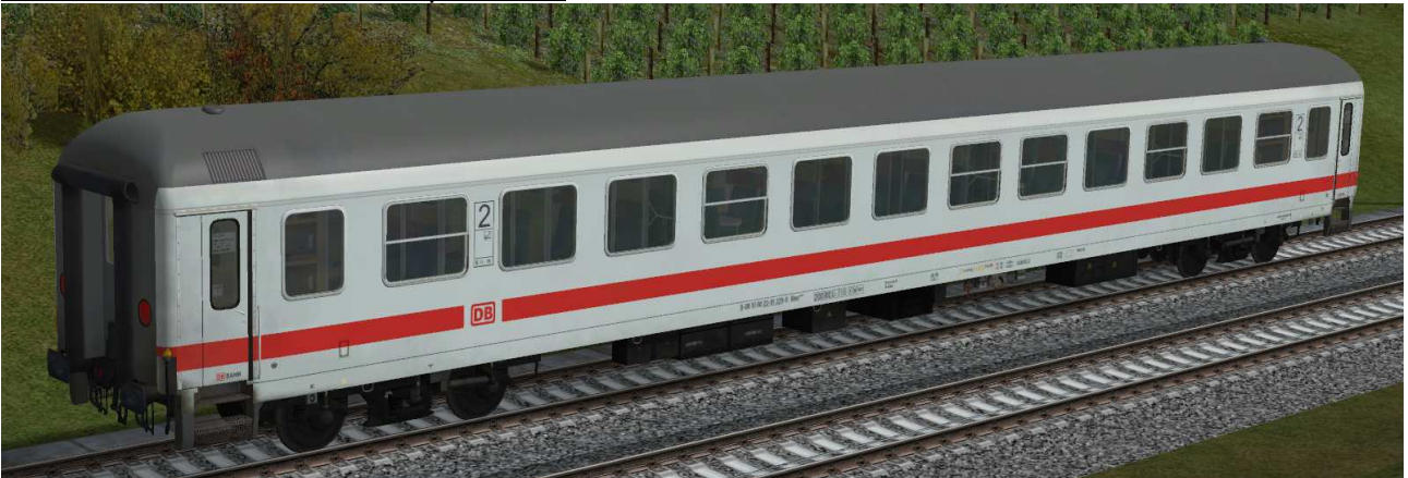
IR-Wagen 2.Klasse – mit geschlossenem WC-System und Mehrspannungseinrichtung
