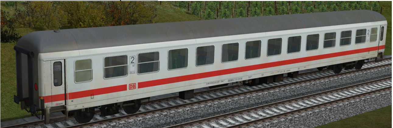
IR-Wagen 2.Klasse – mit geschlossenem WC-System und Mehrspannungseinrichtung
