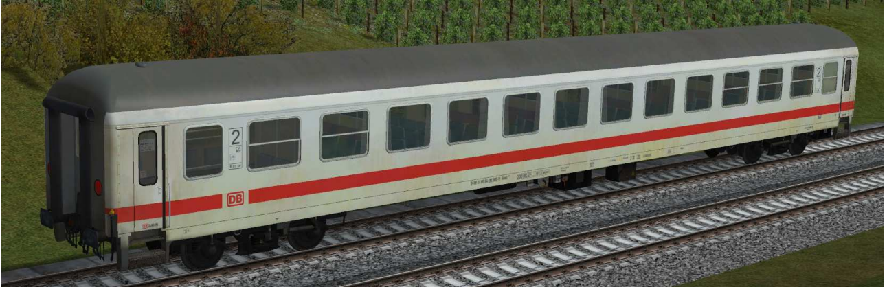
IR-Wagen 2.Klasse mit Fahrradabteil – mit geschlossenem WC-System und Einspannungseinrichtung
