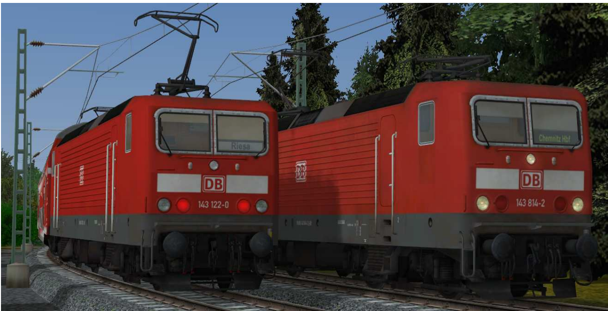
Beleuchtung: 2-Licht-Zugschluß- (links) und 3-Licht-Spitzensignal (rechts)
