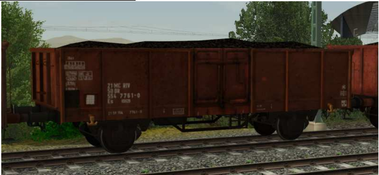
offener zweiachsiger UIC-Standardgüterwagen, Baujahr ab 1981 in der Waggonfabrik Vagonka Ceska Lipa
