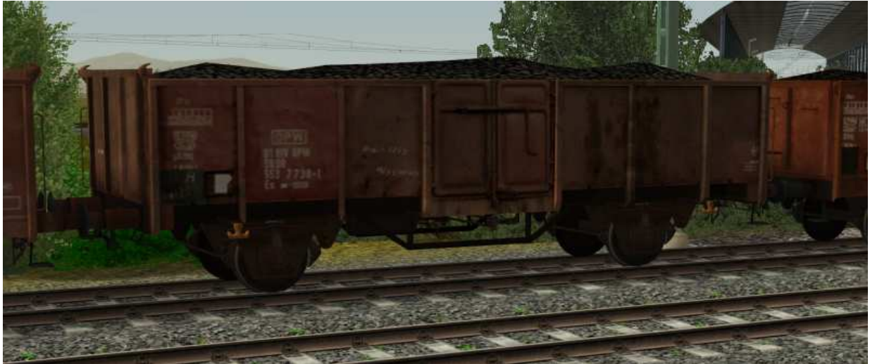
offener zweiachsiger Rekogüterwagen nach UIC Standard II, gefertigt im RAW Dresden ab 1964
