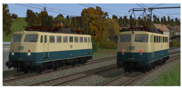
Beleuchtung: 2-Licht-Zugschluß- (rechts) und 3-Licht-Spitzensignal (links)
