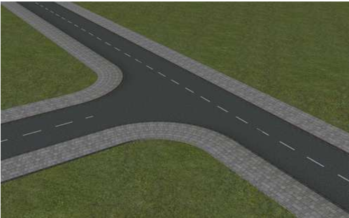
Straßeneinmündung mit Gehwegen Radius 20 m
