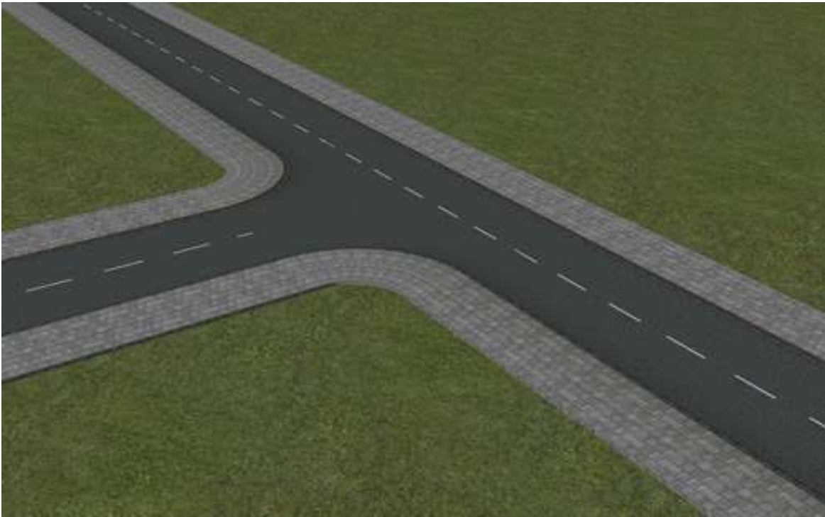
Straßeneinmündung mit Gehwegen Radius 15 m
