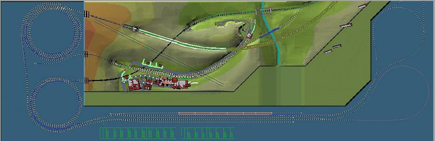
Etwas verwirrend wirken beim ersten „Studium“ der Anlage die Gleisspiralen außerhalb des gestalteten Bereiches. Das Grundprinzip allerdings ist eigentlich nichts anderes als zwei verschlungene Gleisovale der Haupt- und Neubaustrecke im zweigleisigen „Hundeknochenprinzip“.
