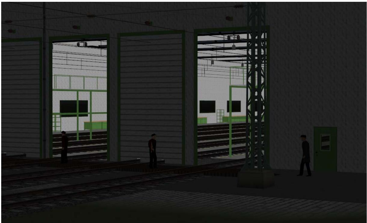
Die Hallen haben 3 Ebenen, das Kellergeschoss ist zur Wartung der Drehgestelle sowie der Bremsanlagen vorgesehen und die Arbeitsbühnen für die Wartung der Stromabnehmer und Dachleitungen.
