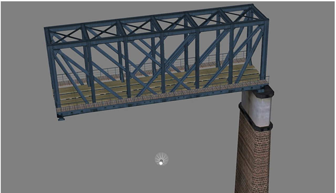
Gleisobjekt Biehl_1_FWK_27_m_Pf_AF1 , 27 m lange Fachwerk—Kastenbrücke mit festem und beweglichem Auflager sowie 21 m hohem Pfeiler
